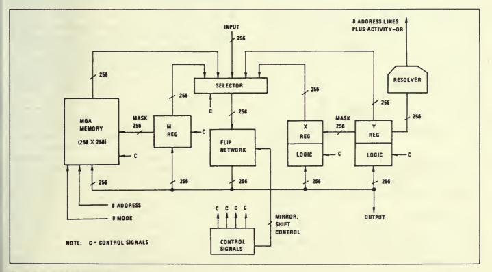
Fig. 4. STARAN array module.
